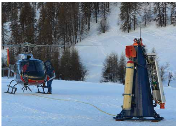
L'innovativo sistema della campana DaisyBell permette di effettuare il distacco pilotato della valanghe attraverso scariche sonore
